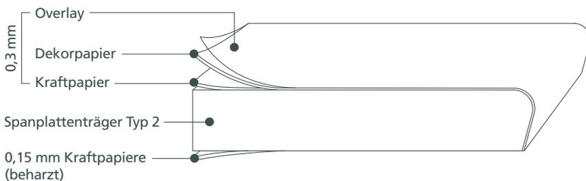
22 mm Qualitätsspanplattenträger Typ P2 nach DIN EN 312, Oberseite und vordere Kante belegt mit Laminat 0,3 mm, Vorderkante abgerundet, Radius 10 mm. Rückseitige Kante geschützt (weiße Kante 0,3 mm mit EVA-Klebung). Unterseite beharztes Kraftpapier.
